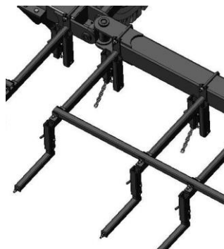
Рисунок 6.2 Крепеж борон к сцепке (слева – зубовых, справа – пружинных)
